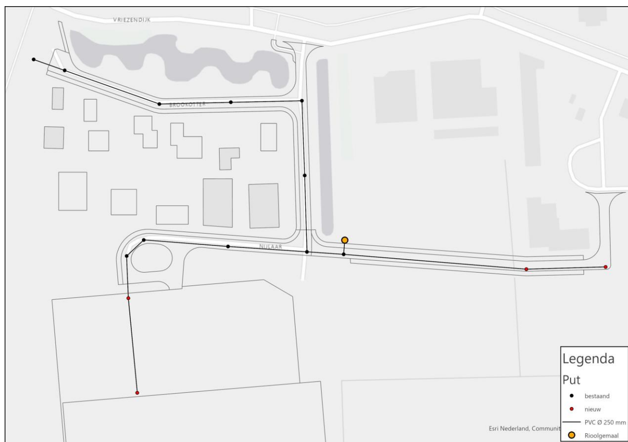
Afbeelding 3.5: Aansluiten DWA-riool op bestaande rioolstelsel.
